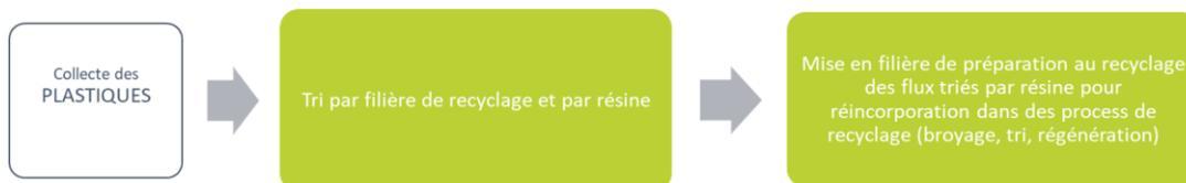
La mise en filière du plastique pour réincorporation nécessite deux niveaux de tri. Un premier tri des plastiques pour les séparer des autres flux puis un tri des plastiques par résine. Les réincorpérateurs de plastiques sont généralement demandeurs d'un type de résine spécifique.
