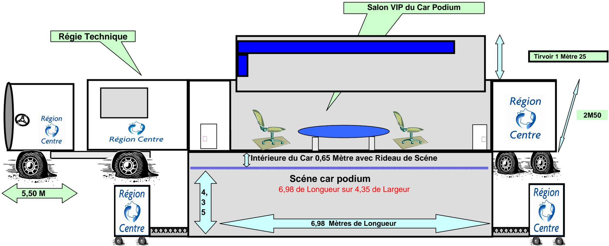
La taille de la semi 2,50 Mètres de large sur 13,07 Mètres de long ainsi que 5,50 Mètres de longueur du tracteur soit 18 Mètres 57 au totale.
